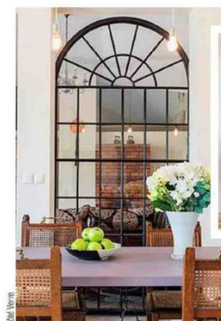
4 Le charme d'une verrière en ferronnerie. Les carreaux se choisissent en verre feuilleté clair ou opacifiant ép. 7 à 9 mm (33.2 ou 44.2). Livrés avec bords polis, ils sont découpés à la forme et à la taille désirées : à partir de 65 €/m².
