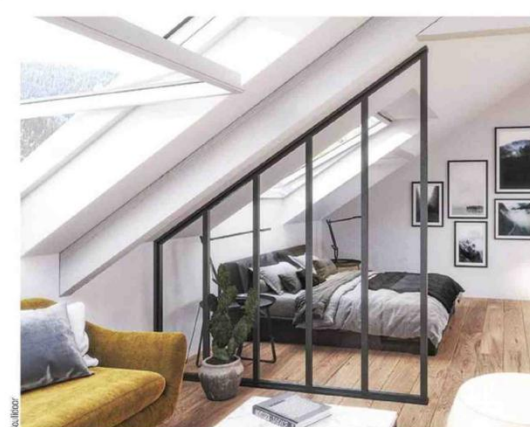
3 Cette verrière sur mesure à pan coupé prévue pour une pose sous pente permet de marquer la séparation originale de l'espace dans des combles aménagés. Profilés en aluminium noir mat avec vitrage clair feuilleté 33.2. Largeur mini : 450 mm. Angle du pan coupé : 50° maxi.
